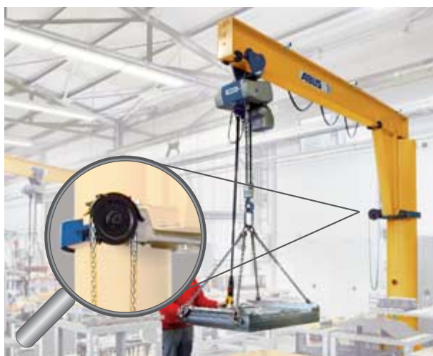
Nastavovacia brzda (obrázok 9)
