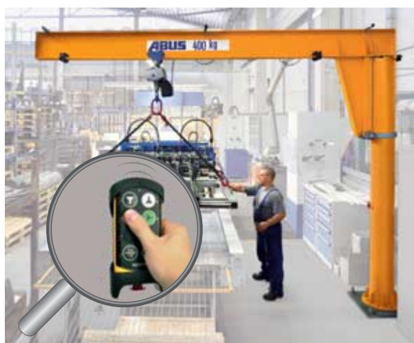
Diaľkové ovládanie (obrázok 12)
